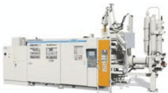
主に自動車用のアルミ成形品を製作する ダイカストマシン
