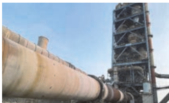
大型鋼構造物を代表する セメント原料を焼成する窯業機（キルン）
