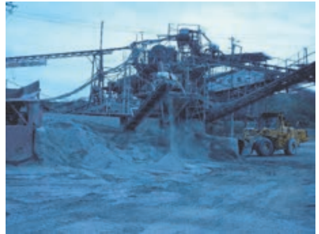
砕石製造プラント
